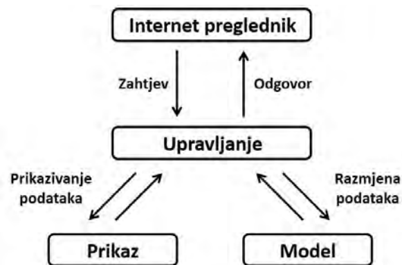
Slika 4.4. Prikaz protoka podataka u MVC arhitekturi.
