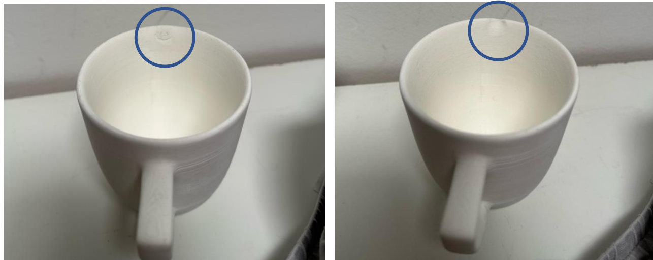
Slika 36: Šalica prije i poslje popravka pomoću 3D olovke
