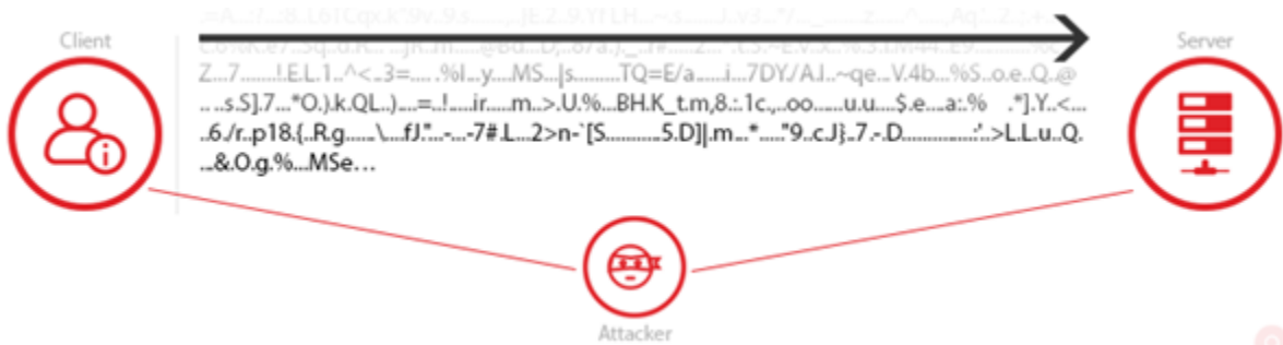
Slika 6 Poruka bez HTTPS enkripcije čitljiva napadaču
