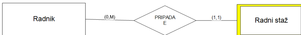
Slika 14 - Primjer egzistencijalnog tipa veze (Pavlic, Oblikovanje baza podataka, 2011)
