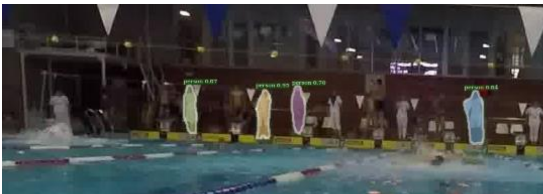
Slika 21. Mask R-CNN detektira osobe na suhom
