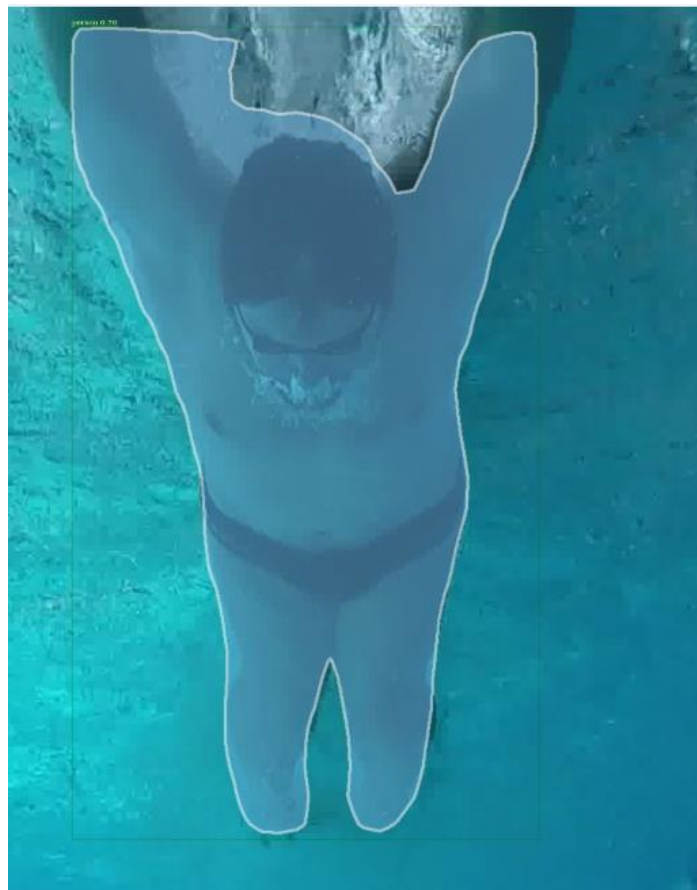
Slika 33. Detektirana osoba, pravilno omeđena
