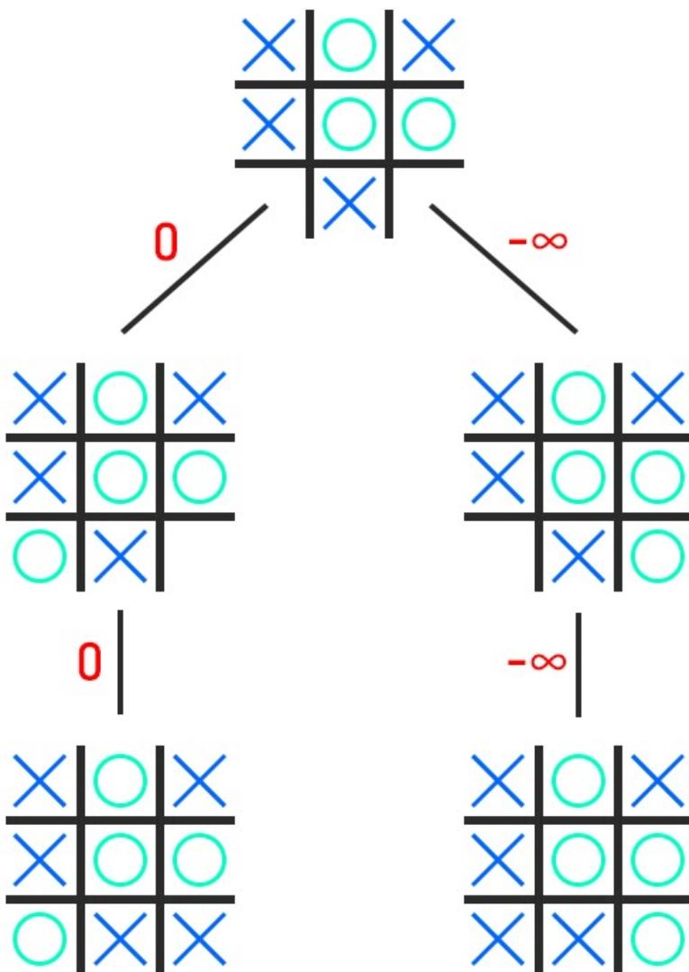
*Slika 1. Primjer izvršavanja minimax algoritma*
