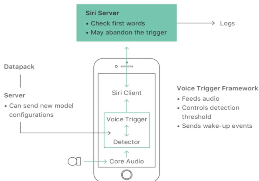
**Slika 8. Dijelovi Siri-a**
