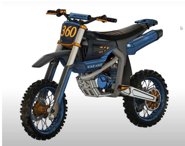
Slika 8. Model izgrađen tehnikom modeliranja površine
