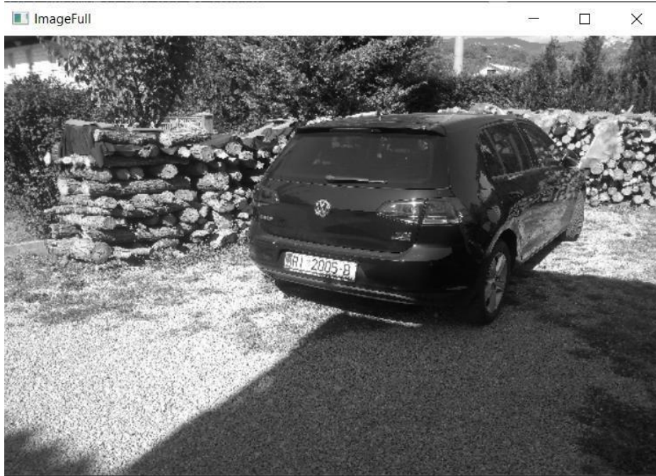
Slika 8. Grayscaled slika poslije cvtColor() funkcije
