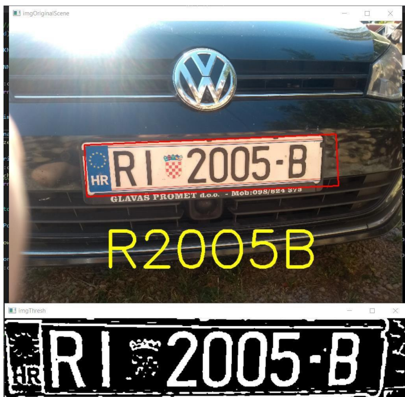
Slika 34. Skoro u potpunosti točno očitana tablica
