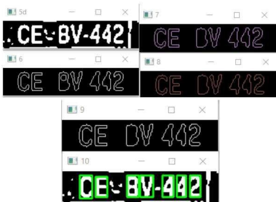
Slika 28. Daljnja obrada slika da bi se dobile točne konture i izvukli znakovi
