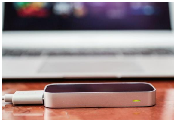
Slika 13 Leap Motion kontroler
