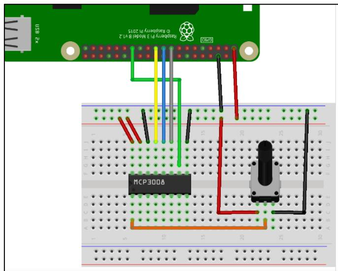
Slika 14. Shema pretvaranja analognog signala potenciometra u digitalni. [9]
