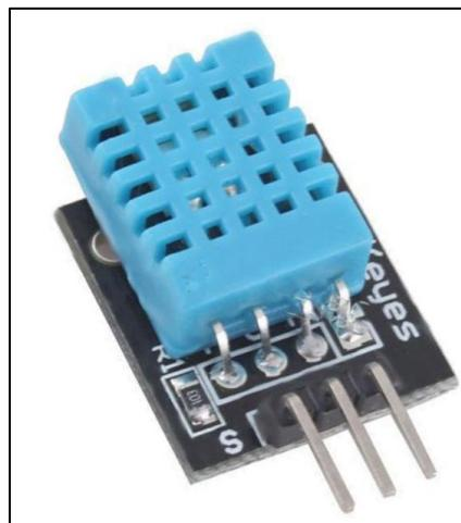
Slika 8. DHT11 Senzor temperature i vlažnosti zraka. [7]
