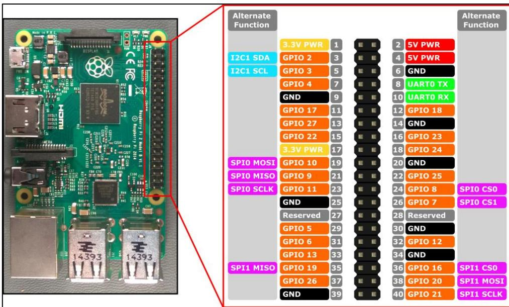
Slika 2. GPIO oznake Raspberry Pi-a 2. [14]
