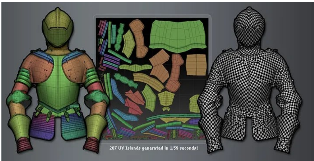
Slika 11: Primjer UV mapiranja 3D modela [17]
