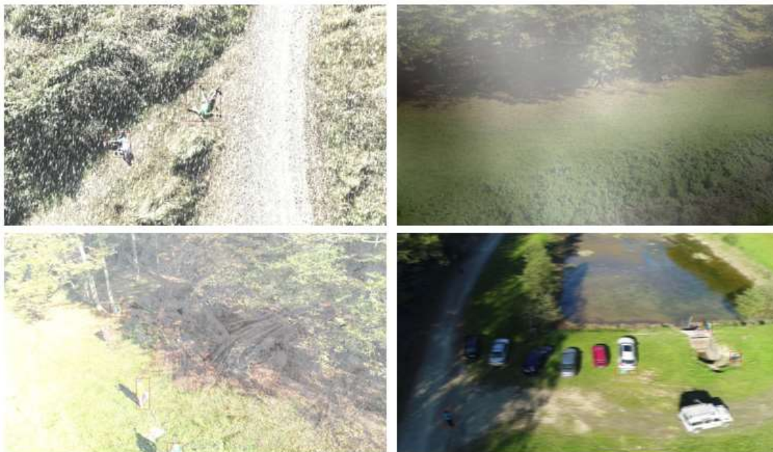
Slika 2.7 Primjer detekcije YOLOv4 modela obučenog na COCO, SARD i Corr skupu podataka. Gore-lijevo snijeg, gore-desno magla, dolje lijevo led, dolje desno zamućenje zbog pomaka kamere [14].
