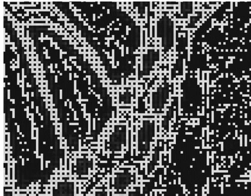
Slika 28. Razlika bilinearne interpolacije i DCCI
