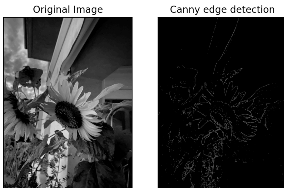
Slika 21. Canny edge detection na slici iz prethodnog primjera ali bez obrade
