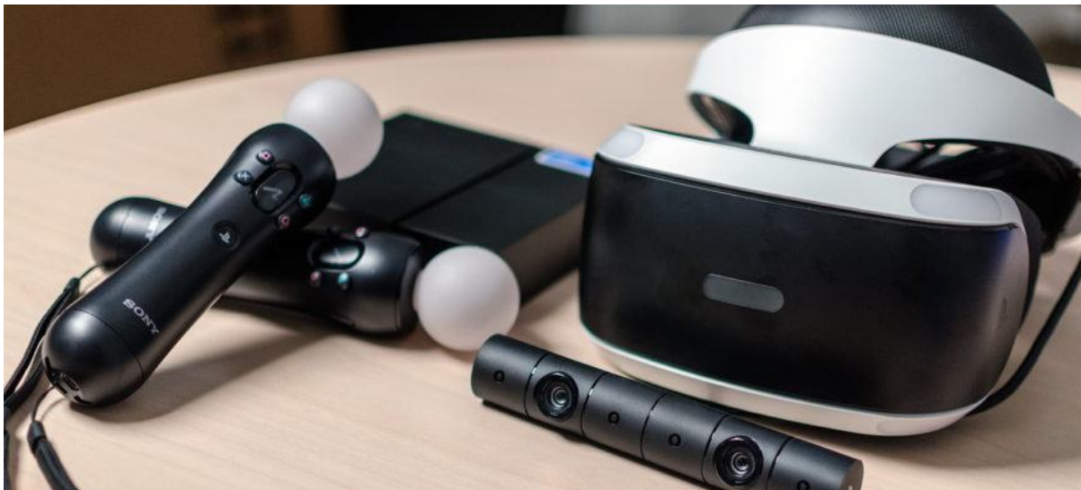
Slika 2 - Prikaz PSVR headseta, kamere, Move kontrolera i procesorske jedinice
