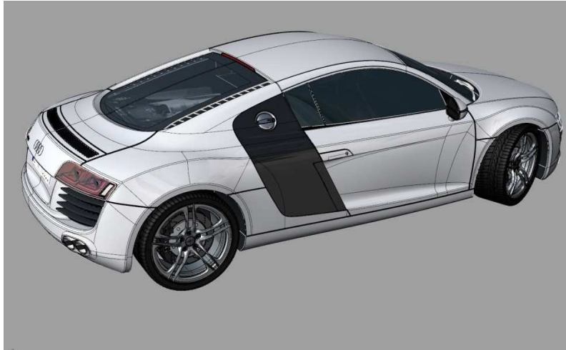
Slika 4. Model izgrađen koristeći se NURBS tehnikom (Izvor: www.ak3d.de )
