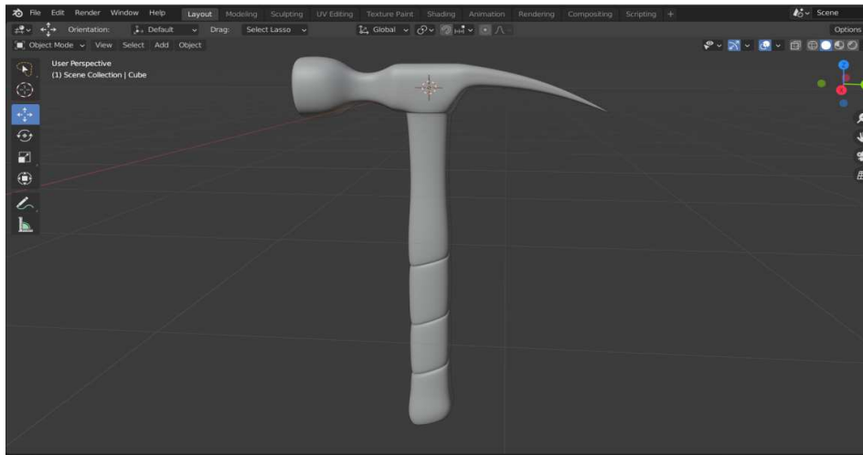
Slika 18. Osmi korak - model nakon primjene shade smooth funkcije
