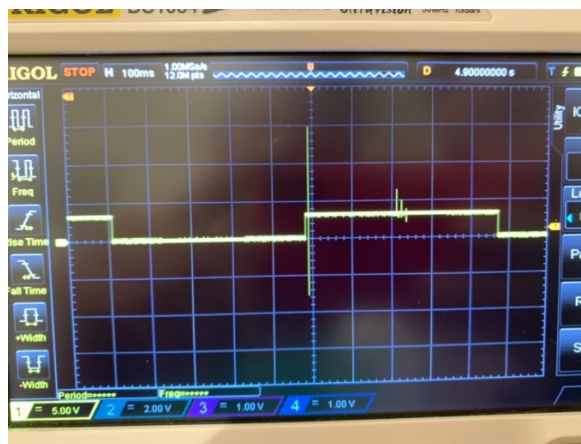
Slika 10 - Osciloskopsko mjerenje elektromagnetskih smetnji - uže
