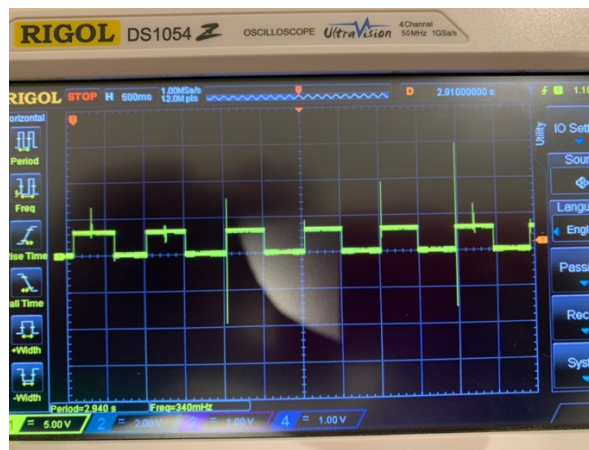
Slika 9 - Osciloskopsko mjerenje elektromagnetskih smetnji - šire
