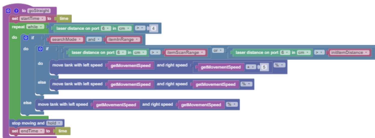
Slika 19 funkcija za micanje robota u ravnoj liniji
