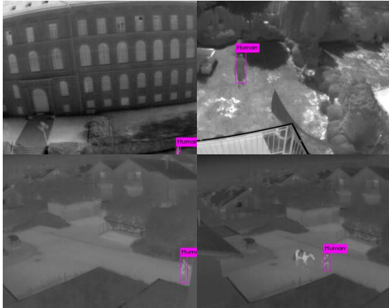
Slika 75. Detekcije na slikama iz skupa ASL ETH FLIR [300, 311]
