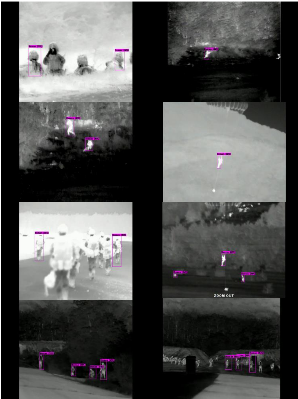
Slika 80. "Swift Response 2019", primjeri detekcije osoba korištenjem naučenog YOLOv3 modela
