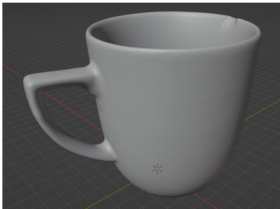
Slika 33: 3D sken šalice sa 1,8 miliona referentnih točaka
