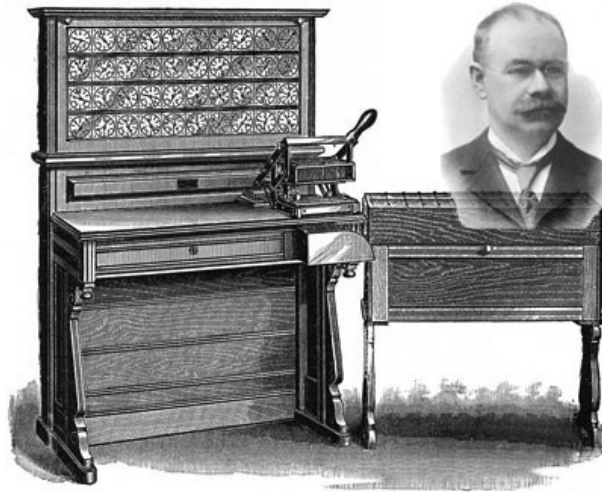
Slika 9. Herman Hollerith i njegov tabulirajući stroj [19]
