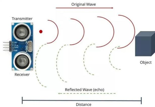
Slika 10 - ilustrirani princip rada ultrazvučnog senzora [7]
