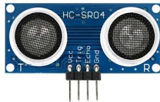
Slika 9 - ultrazvučni senzor HC-SR04
