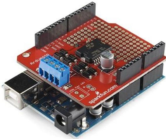
Slika 5 - primjer Arduino modula - Arduino Motor Driver Shiled [5]
