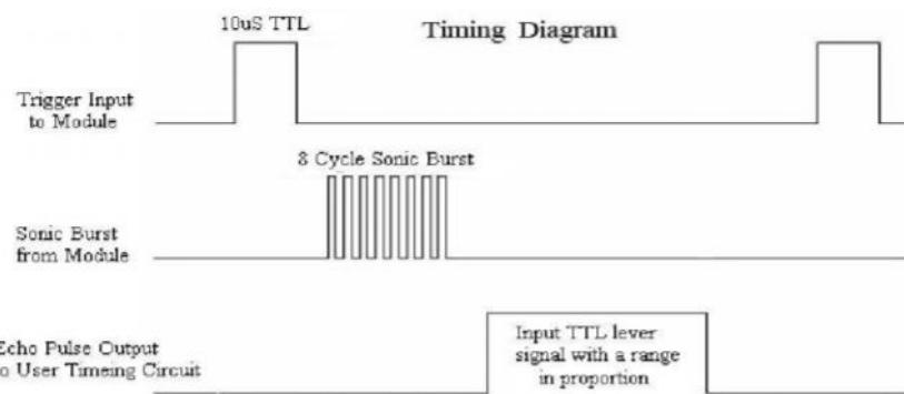
Slika 11 - vremenski dijagram funkcioniranja ultrazvučnog modula [8]
