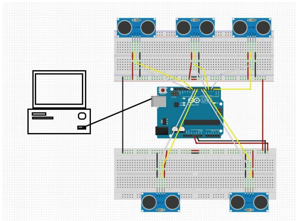
Slika 25 - shema spajanja hardverskih komponenti korištenih u projektu
