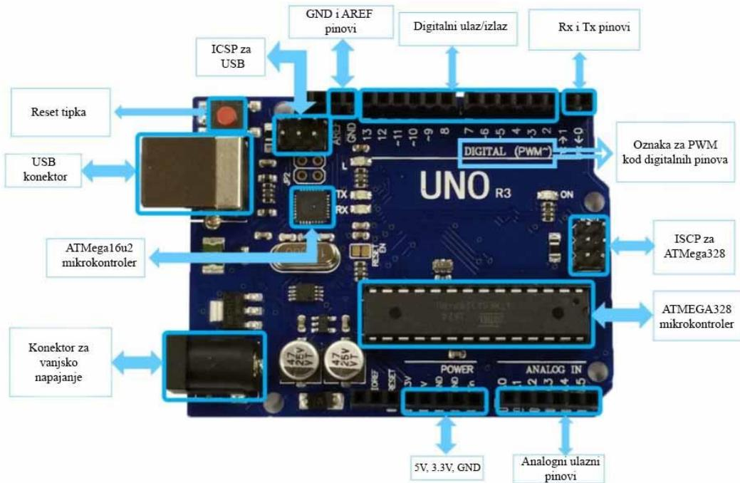
Slika 6 - razvojna pločica Arduino Uno [5]
