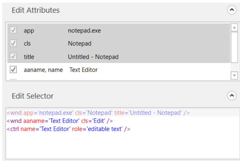
Slika 27. Prikaz djelomičnog selektora (preuzeto iz (UiPath Studio Guide))
