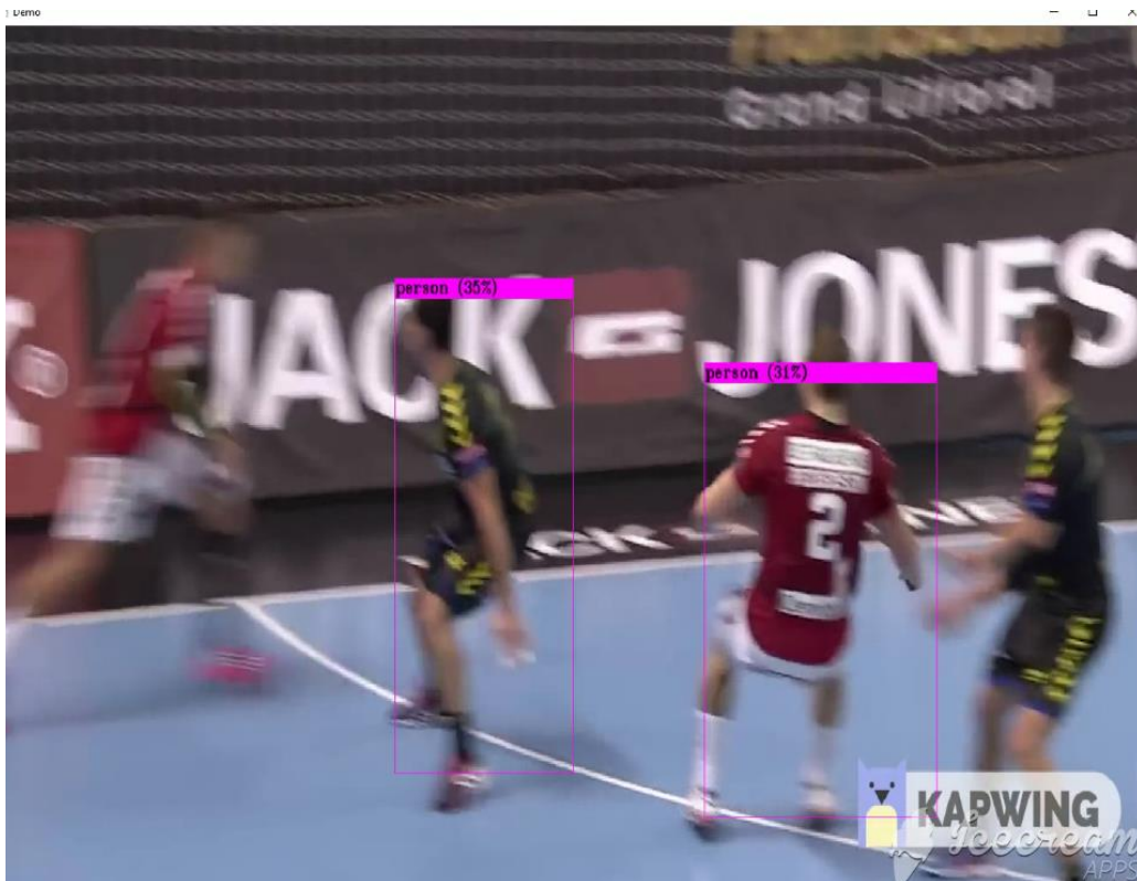
Slika 40: YOLOv3 detekcija rukmetaša u skoku prilikom zamućenog frame-a pomoću metode logističke regresije
