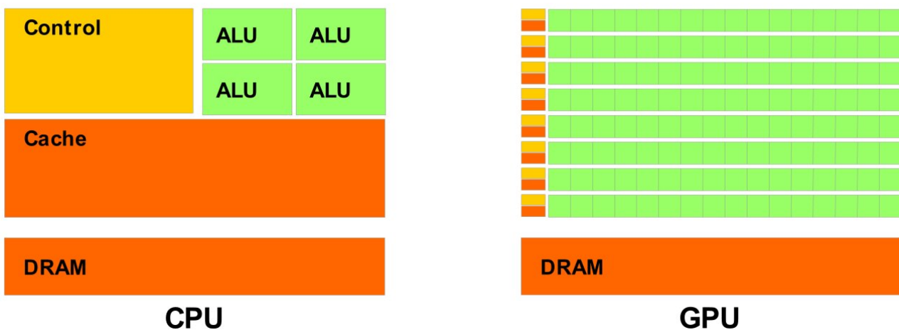
Slika 4: Razlika između arhitekture CPU-a i GPU-a
