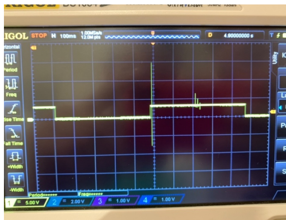
Slika 10 - Osciloskopsko mjerenje elektromagnetskih smetnji - uže
