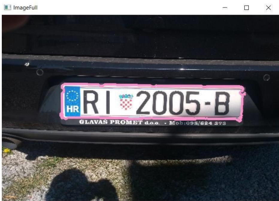
Slika 15. Jedini točan rezultat Canny algoritma
