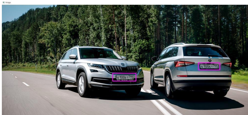
Slika 3. Primjer uspješno očitanih ruskih tablice preko algoritma Haar kaskada
