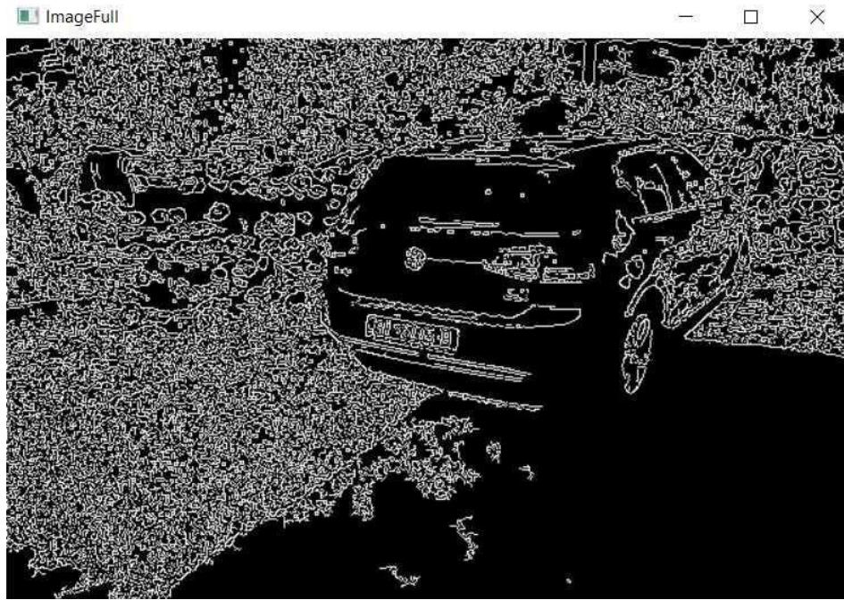
Slika 10. Slika nakon primjene Canny() funkcije
