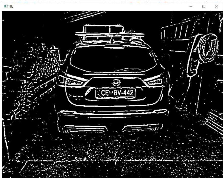
Slika 22. Slika nakon provedenog određivanja praga
