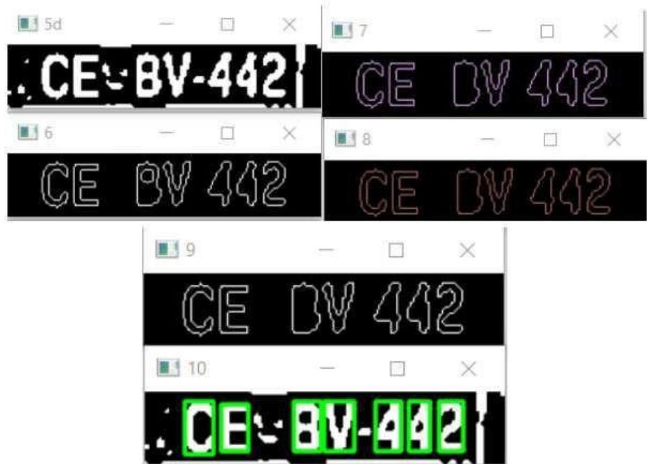
Slika 28. Daljnja obrada slika da bi se dobile točne konture i izvukli znakovi
