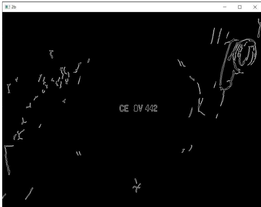
Slika 24. Sa slike su izdvojene samo konture koje program prepoznaje kao moguće znakove
