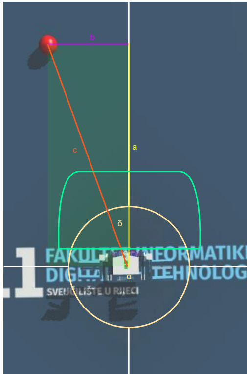
Slika 23 prikaz senzora i generiranog trokuta pri pomaku na x i y koordinatu
