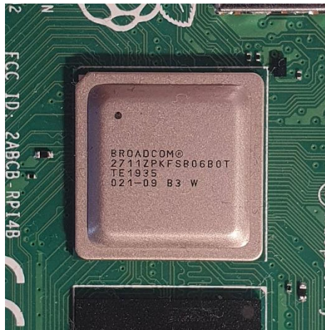
Slika 2: Procesor Broadcom BCM2711
